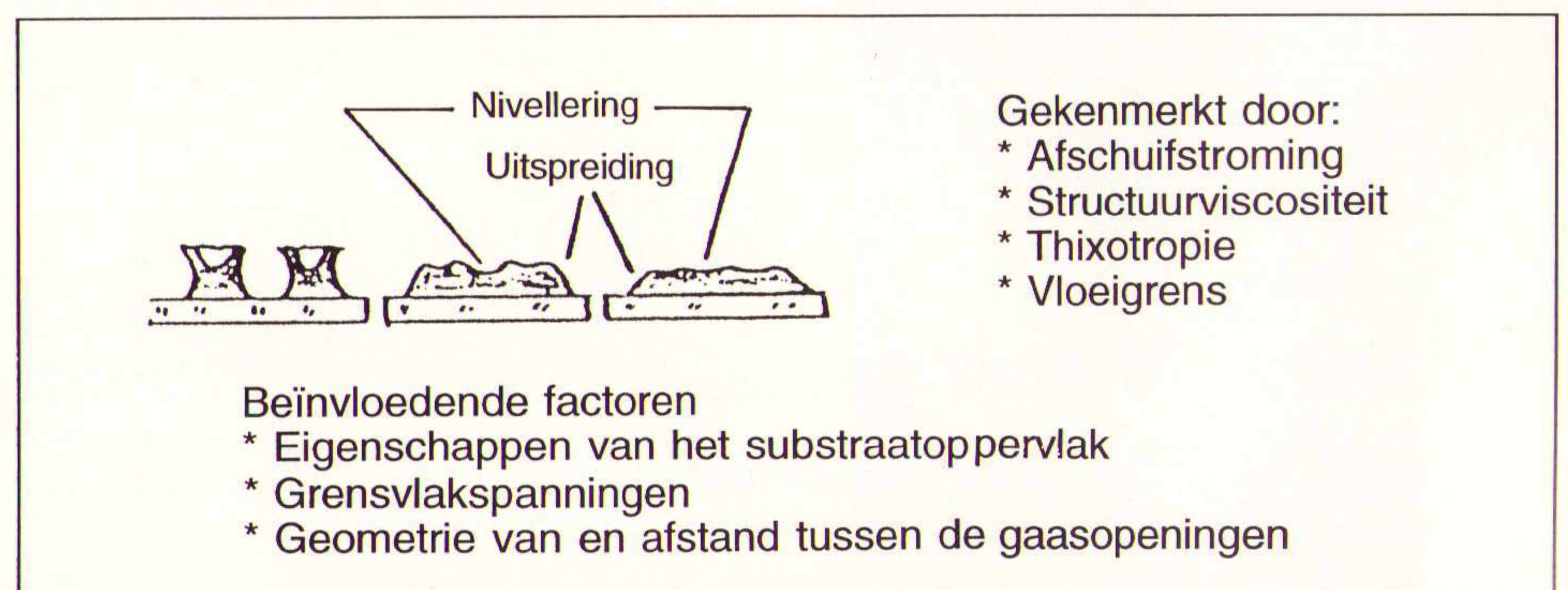
Fig. 15 Nivelleren en uitspreiden.
